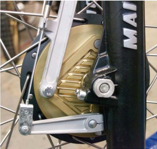
Bremsgestänge V2A mit Kugelgelenk und Feder Baujahr 81
