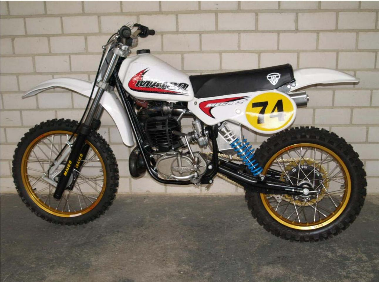
Nabe mit 160mm Bremsdurchmesser gegossen, cnc-bearbeitet, Bremstrommel eingeschrumpft komplett mit Lagern, Bremsschlüssel und Ankerplatte sowie Belägen und Federn, schwarz gepulvert oder Alu natur, doppelte Bremswirkung gegenüber Original
